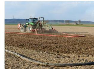
Abb. 1: Traktor mit Gülleverschlauchungstechnik (Foto: Lorenz, Thünen)
