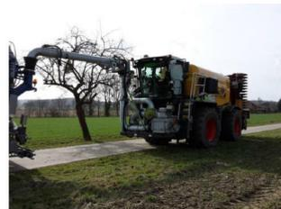
Abb. 2: Selbstfahrender Gülletankwagen (Foto: Weise, Thünen)
