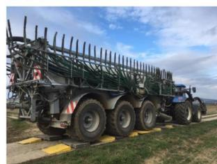
Fig. 4: Traktor mit Tridem-Gülle-fass (Foto: Rolfes, Thünen)
